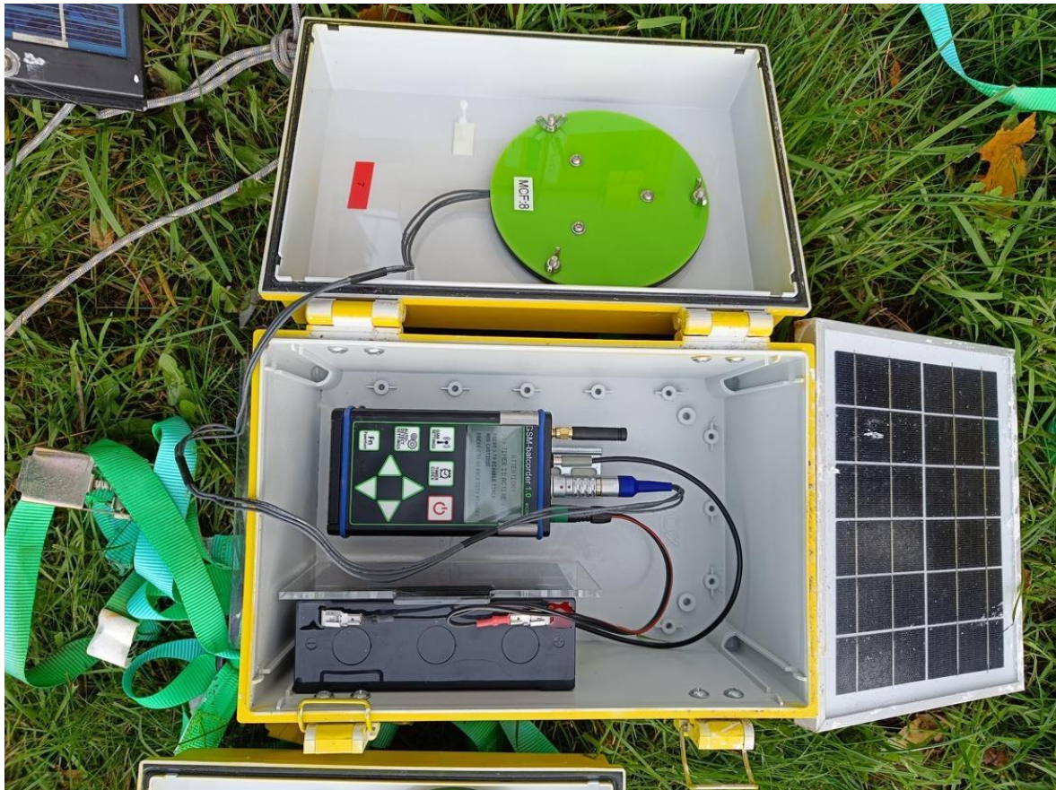
Joonis 7 GSM-Batcorder koos lisakomplektiga.
