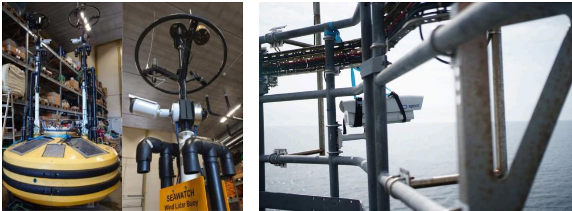
Joonis 3-6. Vasakul: Fugro SEAWATCH ujuvpoi enne kasutuselevõttu. Linnuvaatluskaamerad on paigaldatud kahele postile. Paremal: turbiinile paigaldatav kaamera (Avigilon 61C-H5PRO-B). Albaania. (Spoor, 2024)
