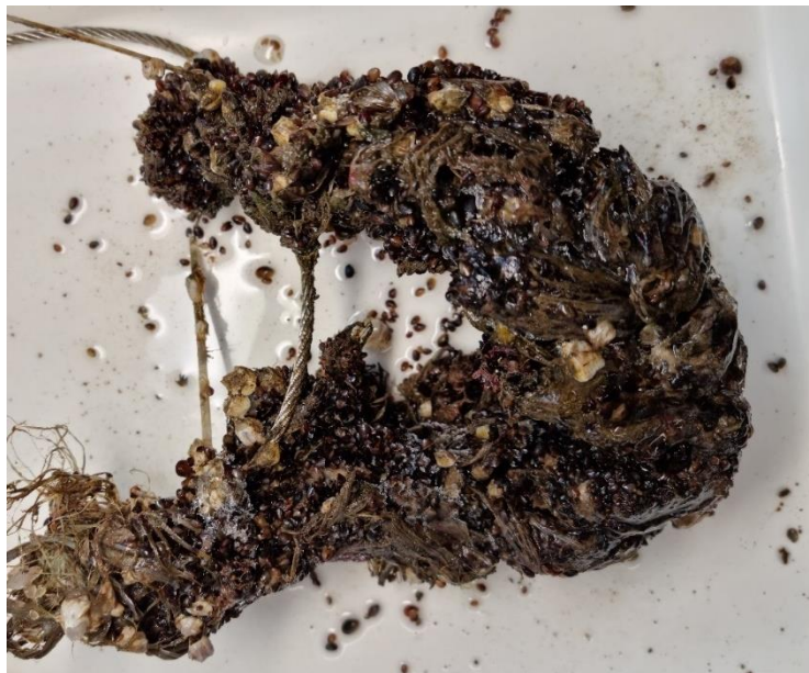
Joonis 3.3.2.1. Näidis eksperimentaal köiest peale 3 kuud vees olekut.
