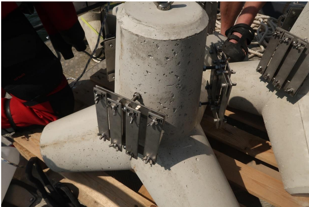
Joonis 2.2.1. Tetrapoodid koos metallist katsepaneelidega enne vette paigaldust.
