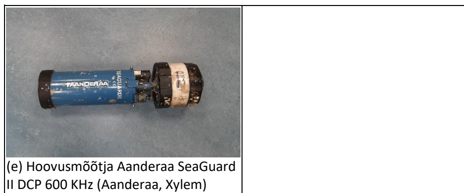
Joonis 2.2.2. Saare-Liivi meretuulepargi arendusalal kasutatud pidevmõõteseadmed.
