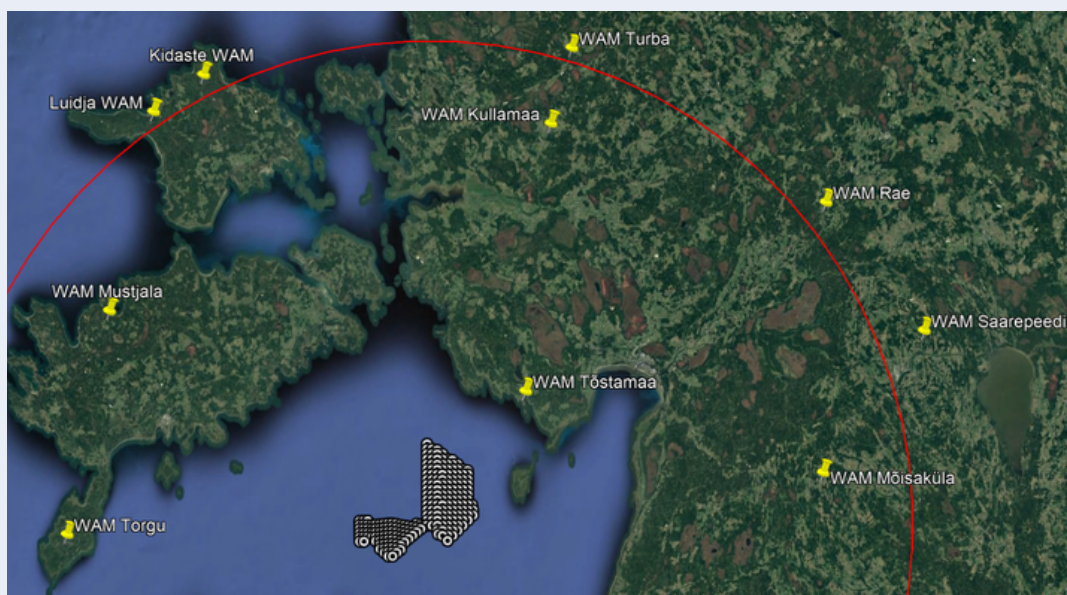
Joonis 11. Tuulepargi nähtavus WAM tugijaamadele 80 m WAM antennide ja 400 m tuulikute korral. Ringi keskpunkt on ligilähedane tuulepargi keskpunktiga ja ringi raadius on 119 km.
