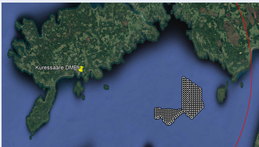
Joonis 12. Kuressaare DME raadiohorisont raadiusega 105 km 400 m tuulikute korral.
