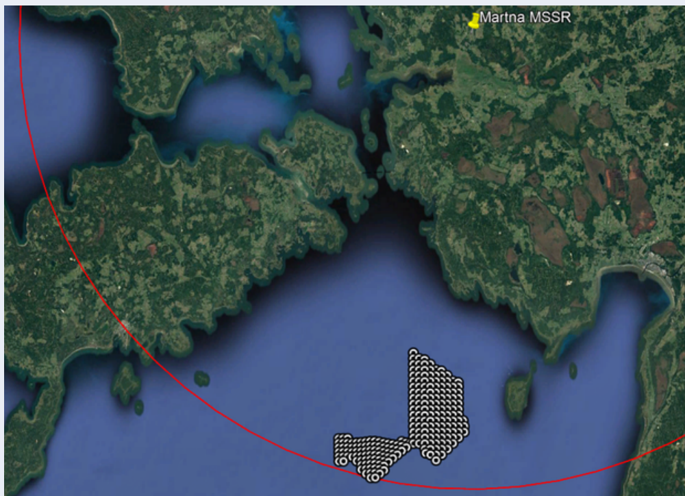
Joonis 10. Martna radari raadiohorisont 400 m kõrguste tuulikute korral.
