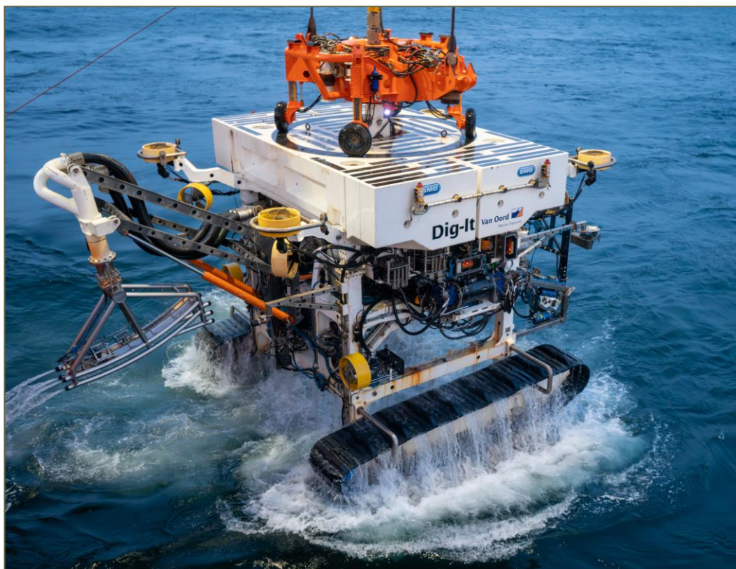
Foto 2.6-2. Kaablite paigaldamise seade „Trencher Deep DIG-IT“ (kaugjuhitav) 21
