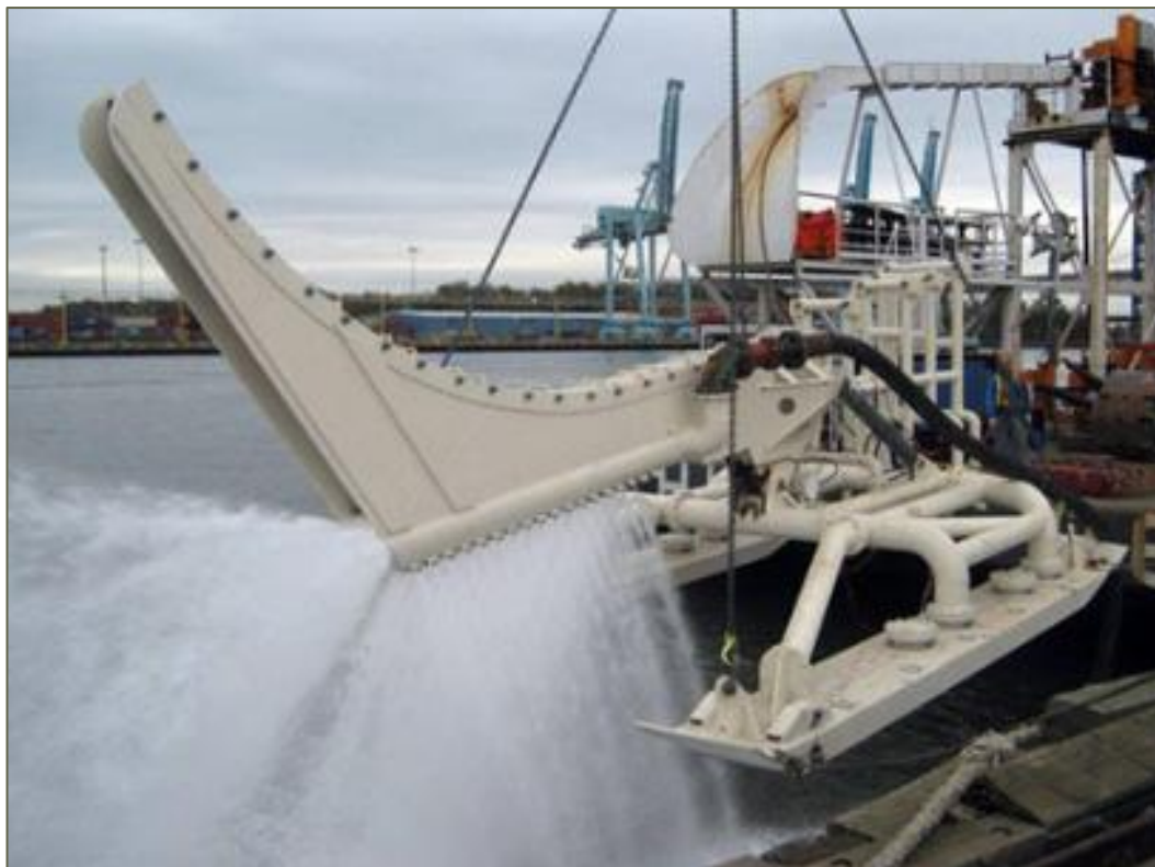
Foto 2.6-1. Kaablite paigaldamise seade „Mod Jet“ (laeva tõmmatav hüdroader) 20
